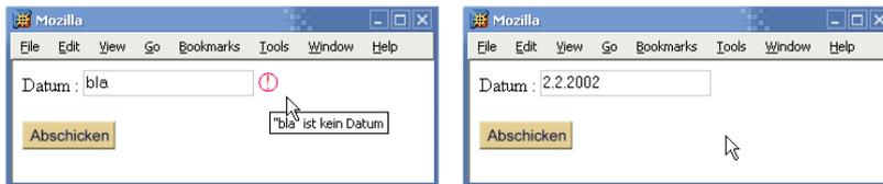
**Abbildung A.1** Beispiel zur sofortigen Validierung. Links: Nach einer fehlerhaften Eingabe; Rechts: Nach einer validen Eingabe
