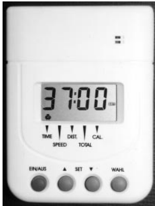
Abb. 21: Die Bedien- und Anzeigeeinheit des Heimtrainers
