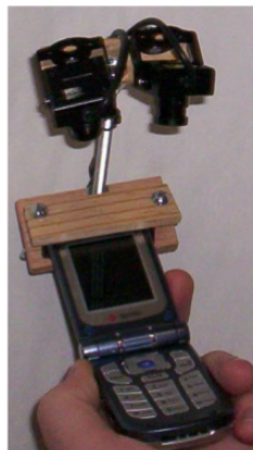
Abbildung 2.11: Video Kamera direkt auf dem mobilen Endgerät befestigt [SWL07].
