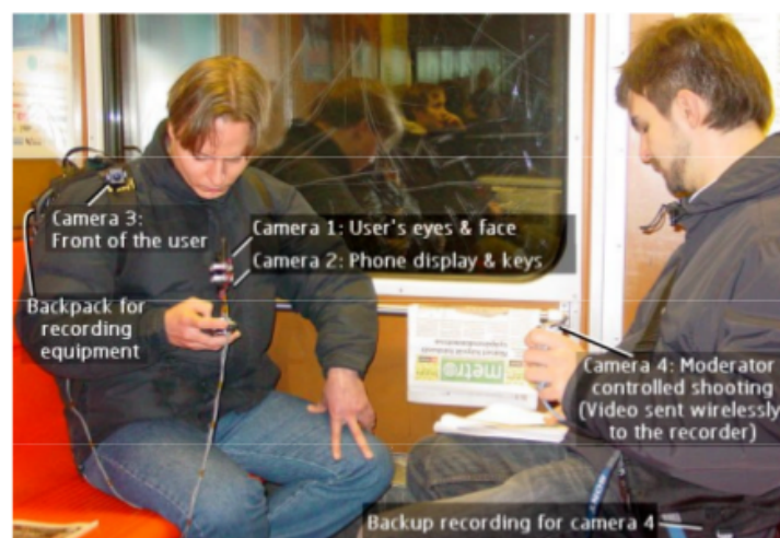
Abbildung 2.12: Usability-Test mit vier Miniaturkameras [ROH + 04].
