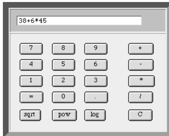
Abbildung 2-8: Ein Taschenrechner als HTML-Formular. Die Funktionalität wird durch Java Skript realisiert (Beispiel aus Self-HTML [Münz 98]), eine Übermittlung von Daten zum WWW-Server findet hier nicht statt
